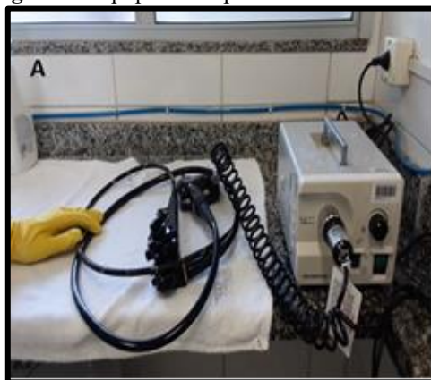
Figura 4: Equipamento para teste de vazamento
