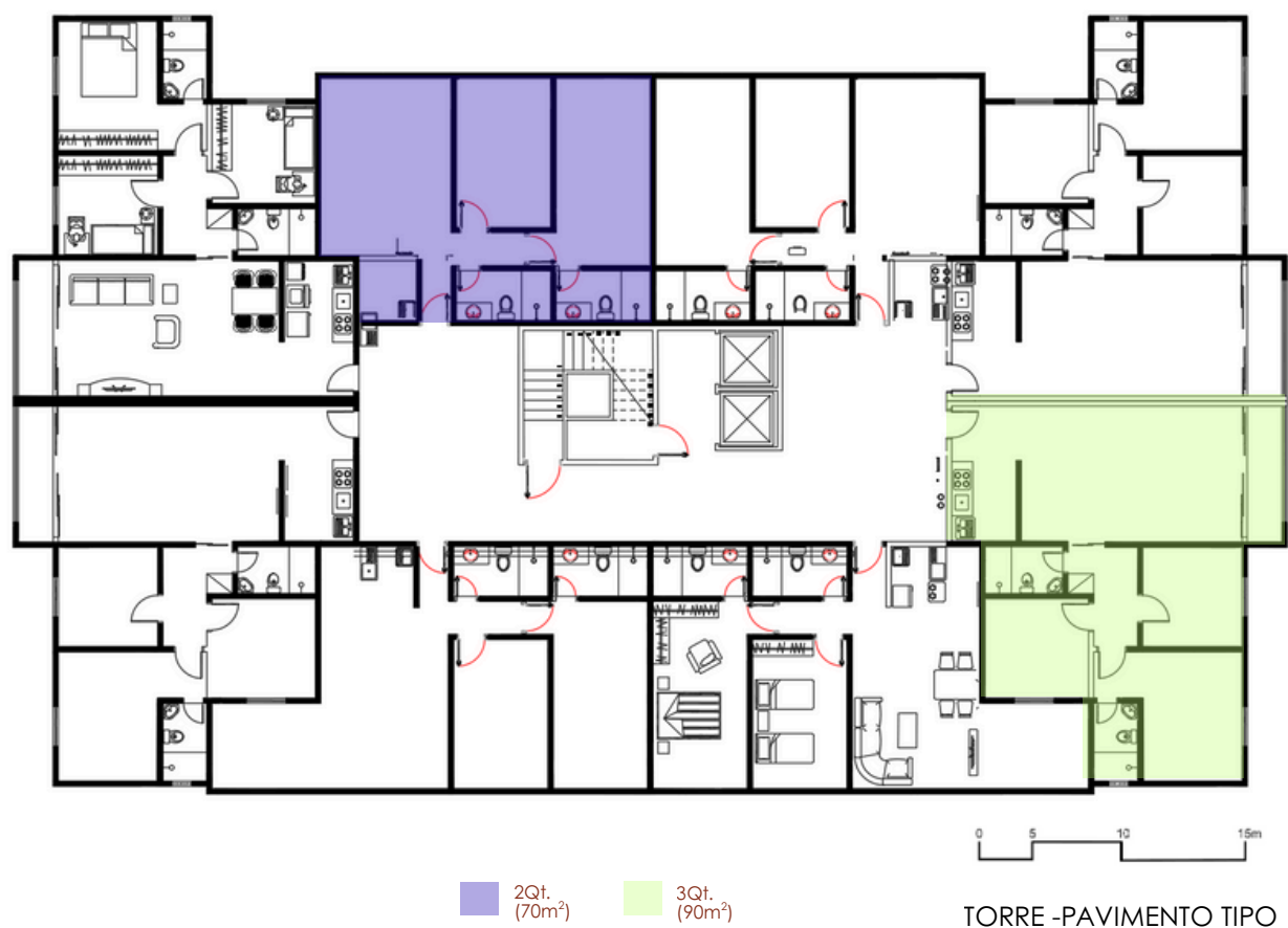
Fig. 106. Planta torre - pavimento tipo
