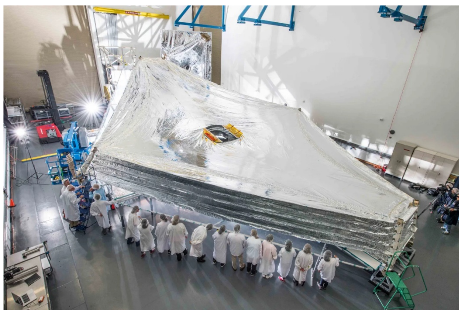
Figura 11: Protetor Solar do JWST
