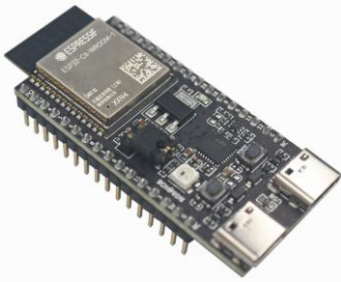
Fig. 3: Vista isométrica da placa de desenvolvimento ESP32-C6-DevKitC-1 Fonte: Espressif Systems [11].
