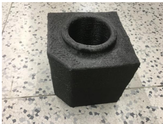
Figura 2.5: Bloco de grafite de Chernobyl de dentro do reator RBMK com versão fragmentada.
