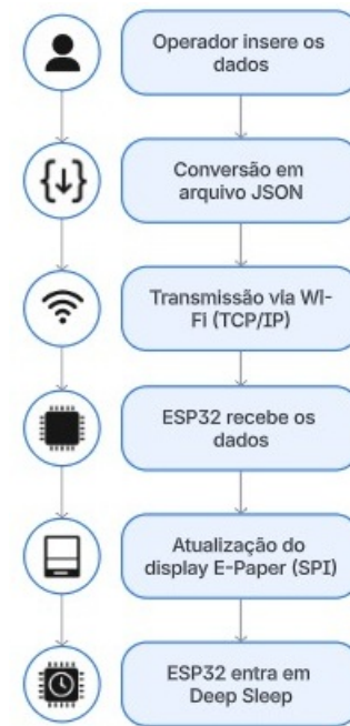
Fig. 3. Diagrama de sequência do firmware.
