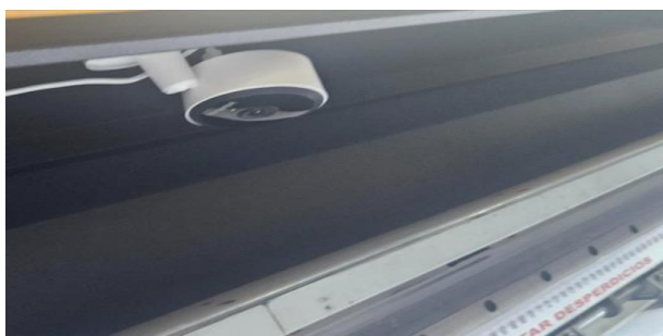
Figura 03. Câmera Intelbras IM1 montada na Impressora K-JET 3204.
