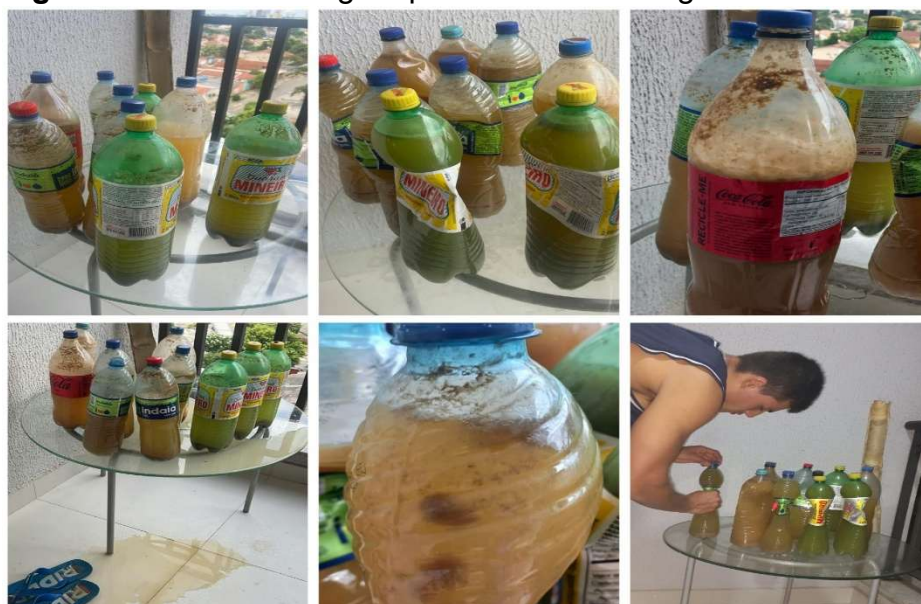
Figura 8 – Retirada do gás que se acumula na garrafa devido a fermentação
