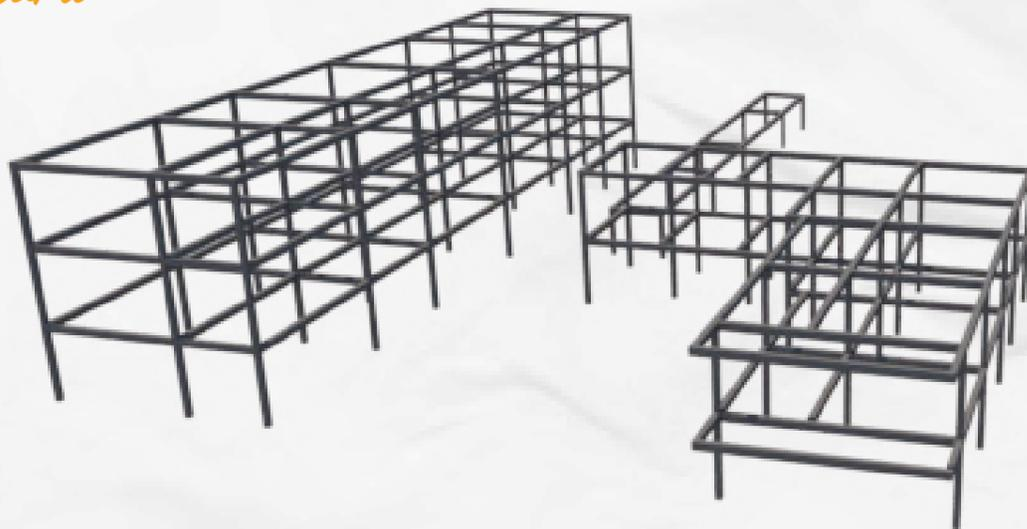
A estrutura metálica foi implantada em todo o projeto por proporcionar grandes vãos, além de ser extremamente resistente e proporcionar uma maior rapidez na obra, já que as peças são criadas em fábrica, com as dimensões e especificações corretas. Por ser um edifício público, a economia e rapidez são pontos importantes para
