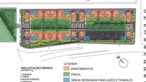
O projeto contempla a construção de 420 unidades habitacionais, cada uma com 50 m<sup>2</sup>, totalizando aproximadamente 31.000 m<sup>2</sup> de área construída. A topografia do terreno foi aproveitada para maximizar o número de apartamentos, permitindo a construção de até oito pavimentos sem a necessidade de elevadores, em conformidade com a legislação.
