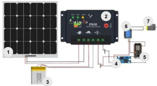
**Figura 3:** Arquitetura Geral do sistema de irrigação automatizada ilustrativo elaborado pelo autor.
