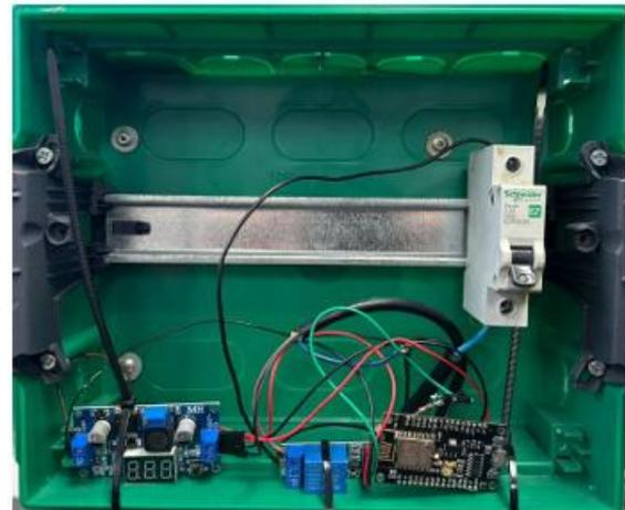
Figura 2.1: Demonstração da ESP8266 no Sistema existente.
