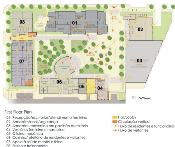
Figura 37 – Planta baixa do pavimento térreo. Fonte: Tatiane Alcântara. 2024.
