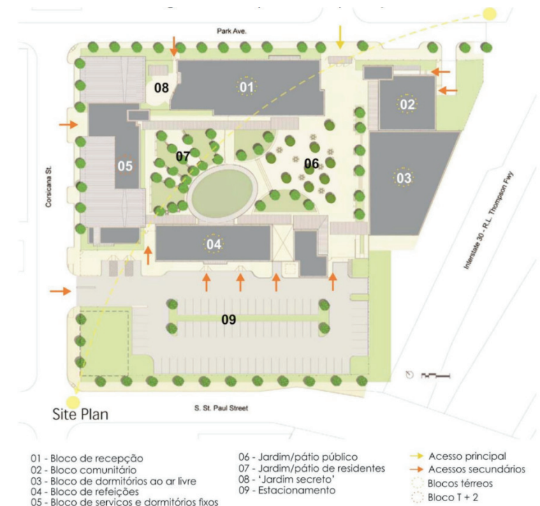
Figura 36 – Esquema de implantação. Fonte: Tatiane Alcântara. 2024.
