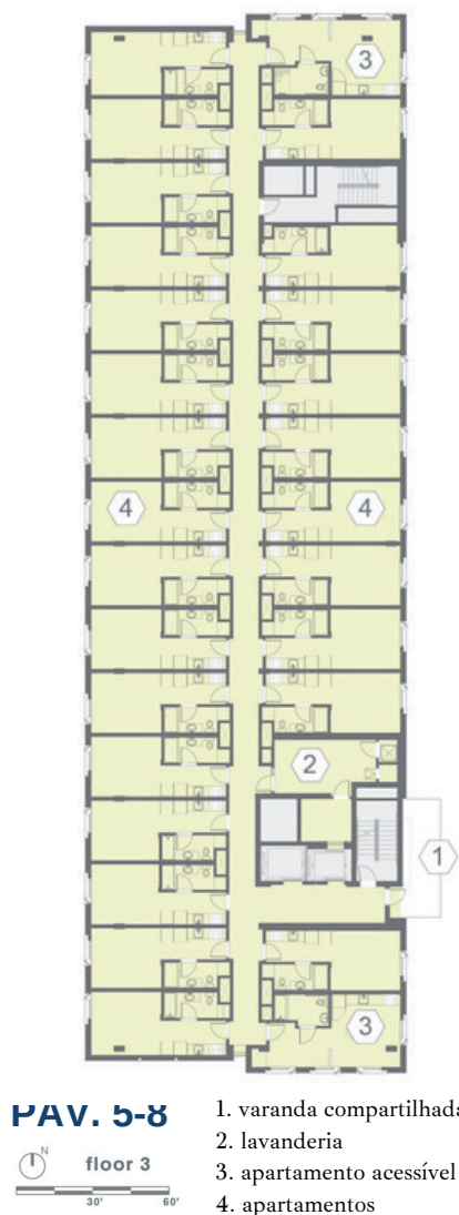
Figura 25 – Planta baixa, PAV.05-08 do BBC. Imagem editada pelo autor. Fonte: Archidaily.
