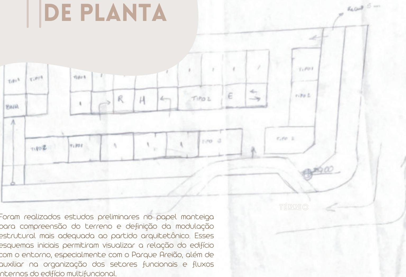
Foram realizados estudos preliminares no papel manteiga para compreensão do terreno e definição da modulação estrutural mais adequada ao partido arquitetônico. Esses esquemas iniciais permitiram visualizar a relação do edifício com o entorno, especialmente com o Parque Areião, além de auxiliar na organização dos setores funcionais e fluxos internos do edifício multifuncional.
