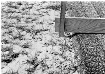
A diferença de elevação entre a borda do pavimento e o acostamento é >25 mm (1") e <50 mm (2")
