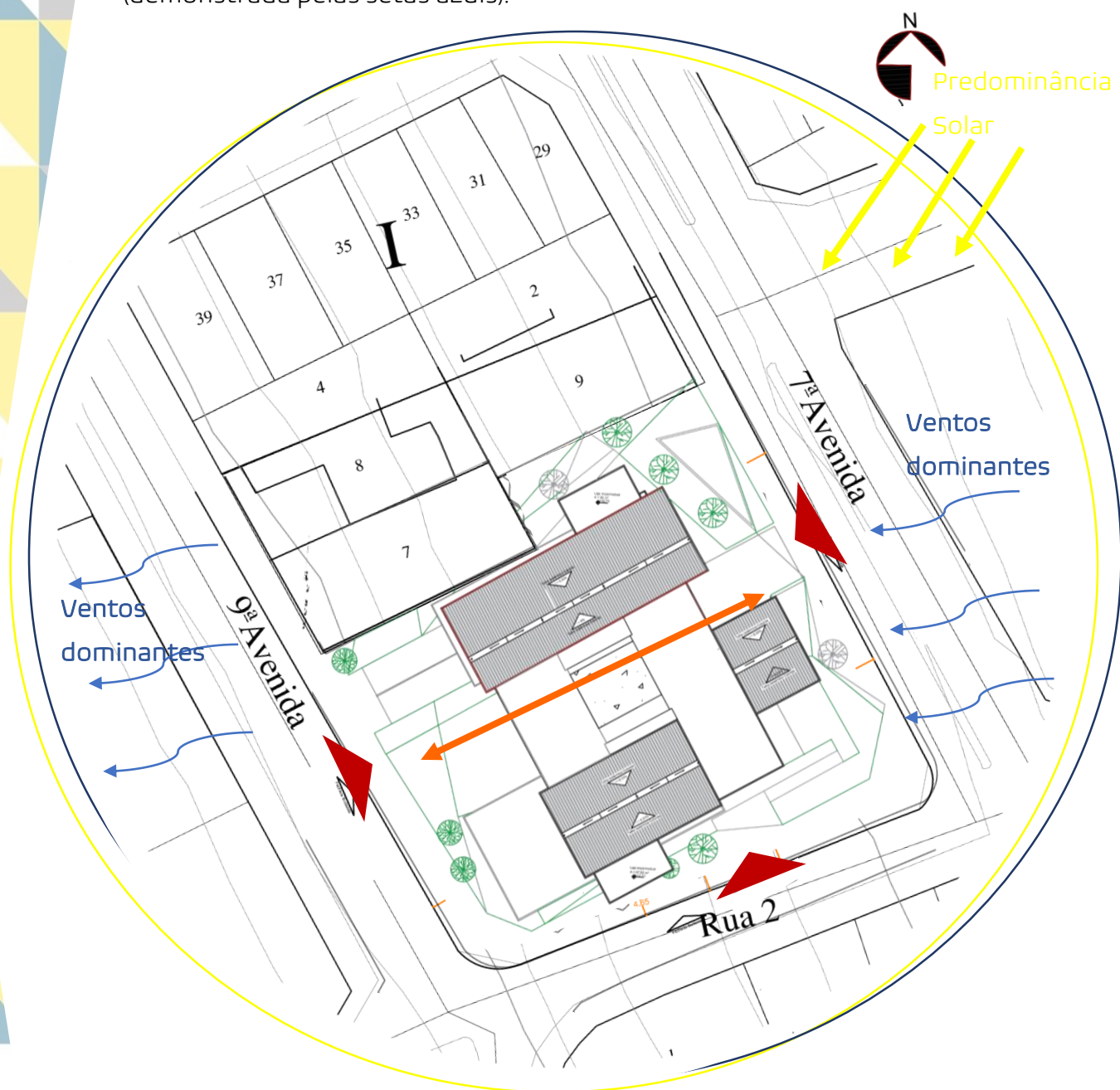
Fig. 5.4: Implantação, Permeabilidade, acessos e Ventos dominantes.
