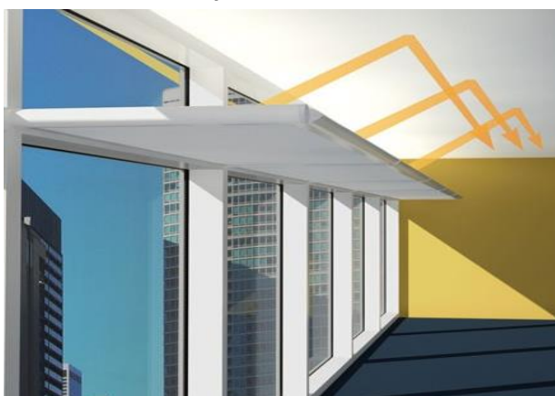
Figura 3. - Detalhe da prateleira de concreto fornecendo iluminação natural indireta para o ambiente.
