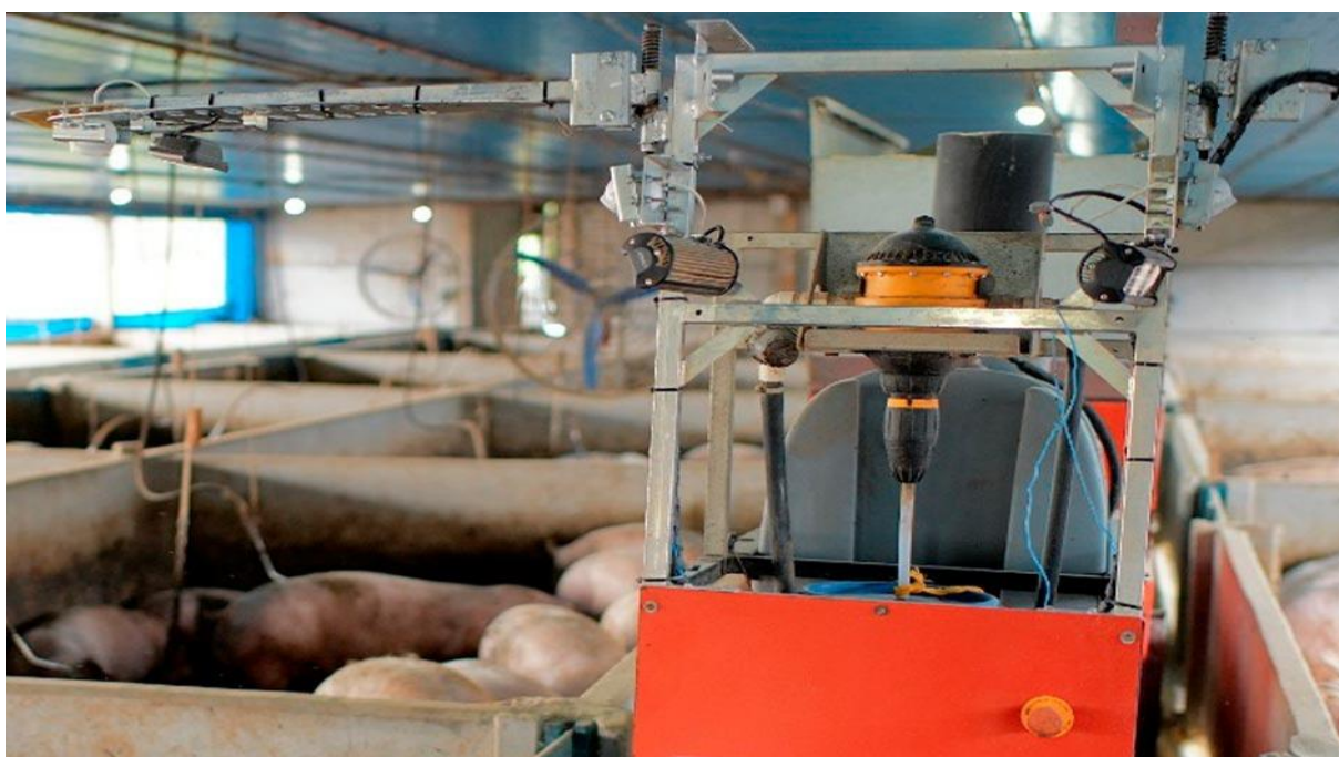
Figura 9: Robô PIG STAR de avaliação de ganho de peso individual, sanidade e bem-estar
