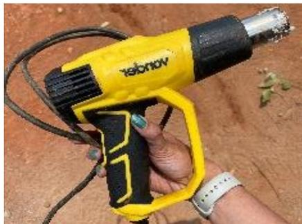
**Figura 6: Soprador para instalação dos eletrodutos e tubulações hidráulicas .
