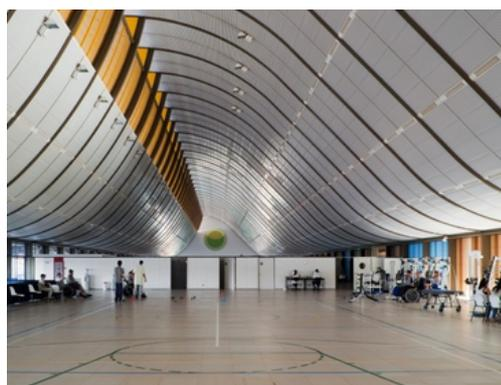
Figura 58. Interior do Centro de Reabilitação Sarah Kubitschek Lago Norte, em que a argamassa armada e aço foram utilizados como sistema estrutural.
