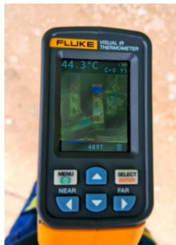
**Figura 16:** Relato fotográfico da câmera termográfica destacando as temperaturas do disjuntor geral depois das modificações necessárias [Autores].
