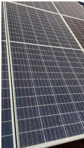
**Figura 13:** Relato fotográfico de um módulo quebrado encontrado durante a visita da usina fotovoltaica localizada no Polo industrial Senador Canedo, Goiás. [Autores]
