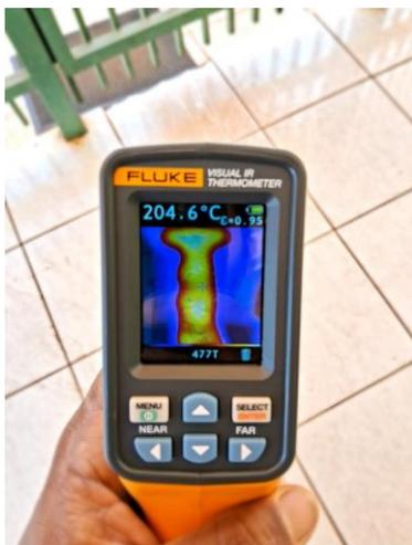
**Figura 15:** Relato fotográfico da câmera termográfica destacando as temperaturas do disjuntor geral antes das modificações necessárias [Autores].
