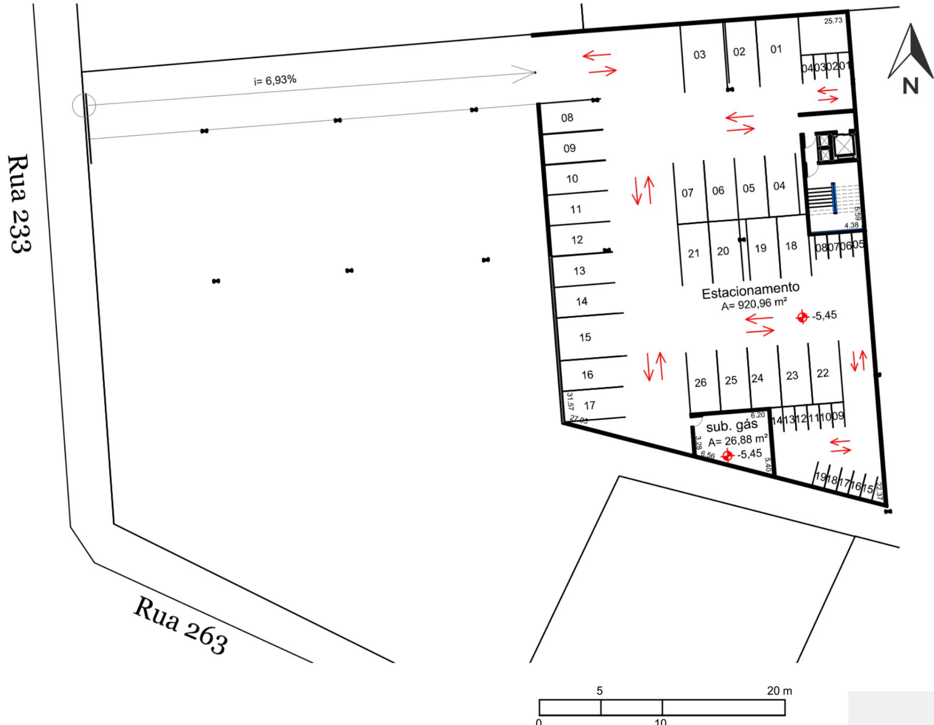
O estacionamento foi desenvolvido em um subsolo criado a partir do aproveitamento do desnível de -8,00 metros entre as ruas 232 e 233, o que possibilitou a implementação de ventilação e iluminação natural através de janelas altas, sendo seu acesso realizado através da Rua 233, possuindo 19 vagas para motocicletas, 23 carros, 2 vagas PCD e 1 vaga destinada para carga e descarga.
