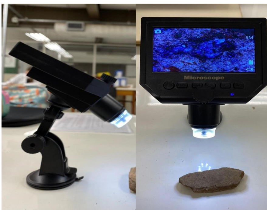
Figura 14 - Registro fotográfico de fragmento cerâmico observado a partir do microscópio digital
