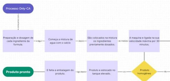
Figura 6. Fluxograma do processo de fabricação antes da automação - Fonte: O Autor
