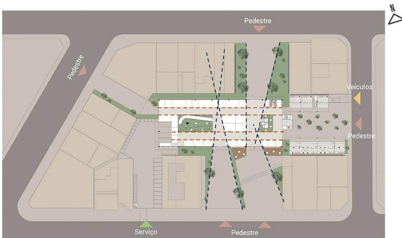
Figura 48: Planta baixa da implantação proposta com os acessos e os traços angulares que nortearam o projeto.
