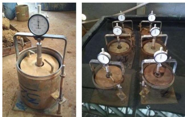
A amostra foi colocada na prensa com os discos usados no ensaio de expansão aplicando aproximadamente 45-KN. Zerou-se o relógio comparador aplicando velocidade de 1,27 mm/min. As leituras do relógio e da célula de carga foram realizadas em intervalos de tempo detalhados em norma.
