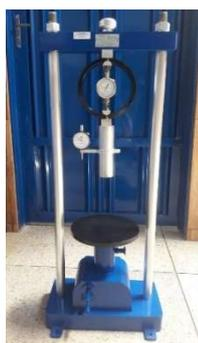
Com os valores medidos obteve-se a curva pressão aplicada versus penetração do pistão e calculou-se o Índice de suporte Califórnia (ISC).
