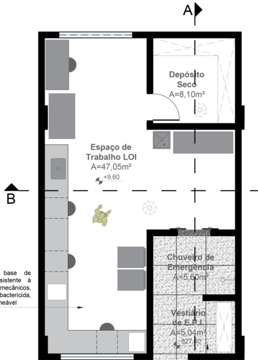
Piso Monolítico à base de Uretano, 8mm - resistente à abrasão, impactos mecânicos, produtos químicos, antibactericida, antiderrapante e impermeável
