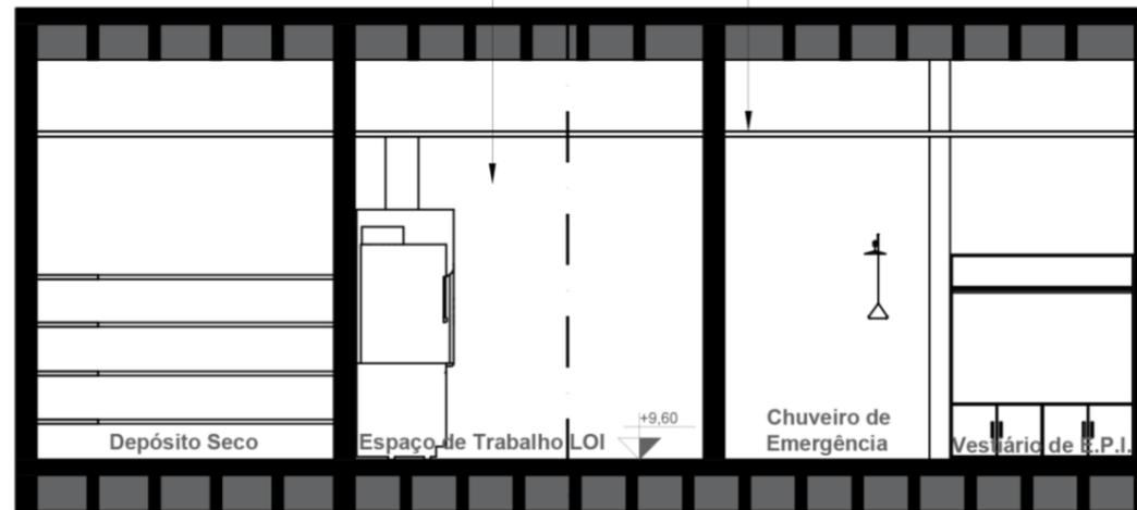
Forro monolítico de gesso acartonado tipo RF, acabamento em tinta látex-acrílica acabamento fosco
