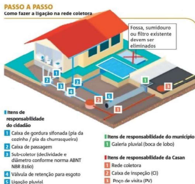
Figura 1- Ligação do sistema de esgoto convencional.
