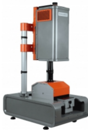
Figura 1 – Estação de trabalho SisuCHEMA para aquisição de amostras HSI-SWIR. [28]
