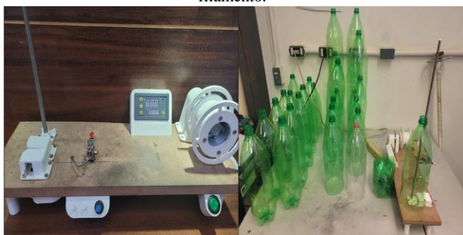
Figura 01: à esquerda, o extrusor de filamentos DIY PETamentor2. À direita, as garrafas de PET reutilizadas para fabricação do filamento.
