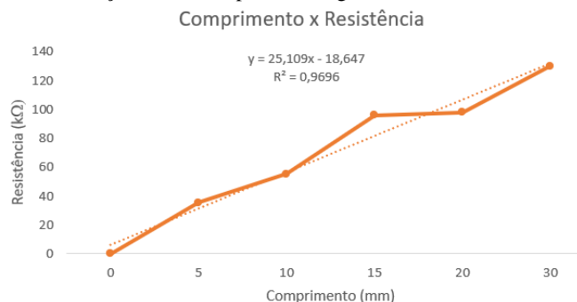
Figura 05: gráfico do comportamento resistivo do compósito em relação ao seu comprimento segundo a lei de Ohm.
