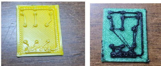
Figura 07: Da esquerda para direita, o modelo da placa impresso em PLA e a PCI impressa com laminado de PET e barramentos de PLA/CB. Modelo próximo ao esperado.
