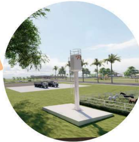
DETALHE CAIXA DE ÁGUA DE 5 MIL LITROS
