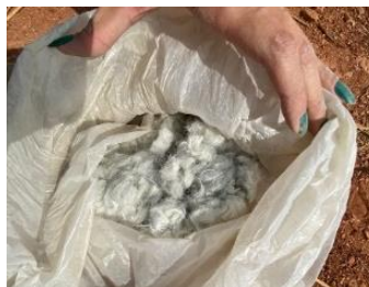
Foto 13 – Fibra de vidro adicionada ao chapisco. Fonte: Próprio autor.
