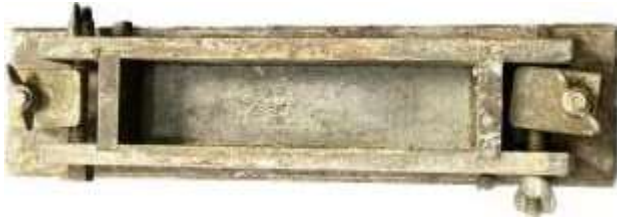
Figura 02: Detalhes do molde metálico prismático.
