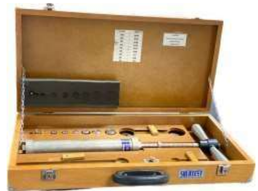
Figura 03: Penetrômetro com agulhas utilizados para ensaio de determinação de tempos de pega.
