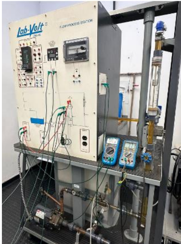
Figura 18: Montagem da Planta de Vazão
