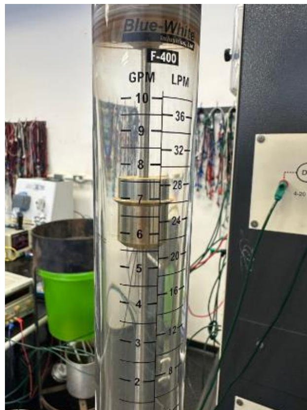
Figura 19: Rotâmetro Indicando a Vazão
