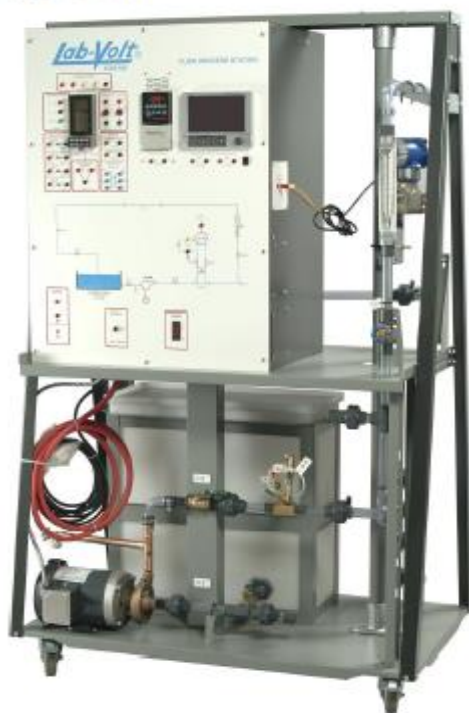
Figura 5: Estação de estudo da variável de processos Vazão – 3502-M0 – Lab Volt Fonte: [17]
