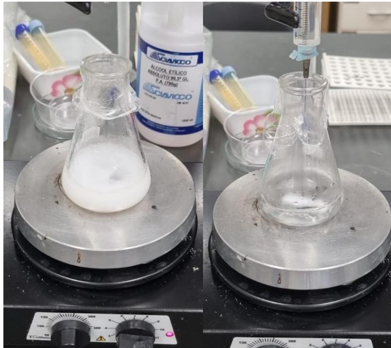
Figura 1: Nanosistemas recém preparados: a esquerda frasco contendo nanosistema NPs-VitE e a direita frasco contendo nanosistema NPs-Vazia.
