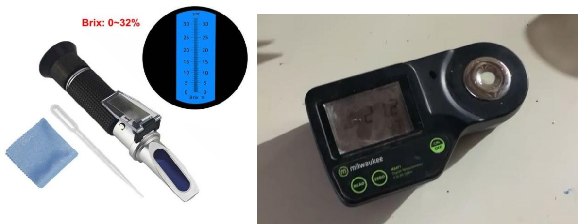
Figura 3 – Refratômetro de brix óptico (esquerda) e brix digital (direita). Fonte: Arquivo pessoal (2023).
