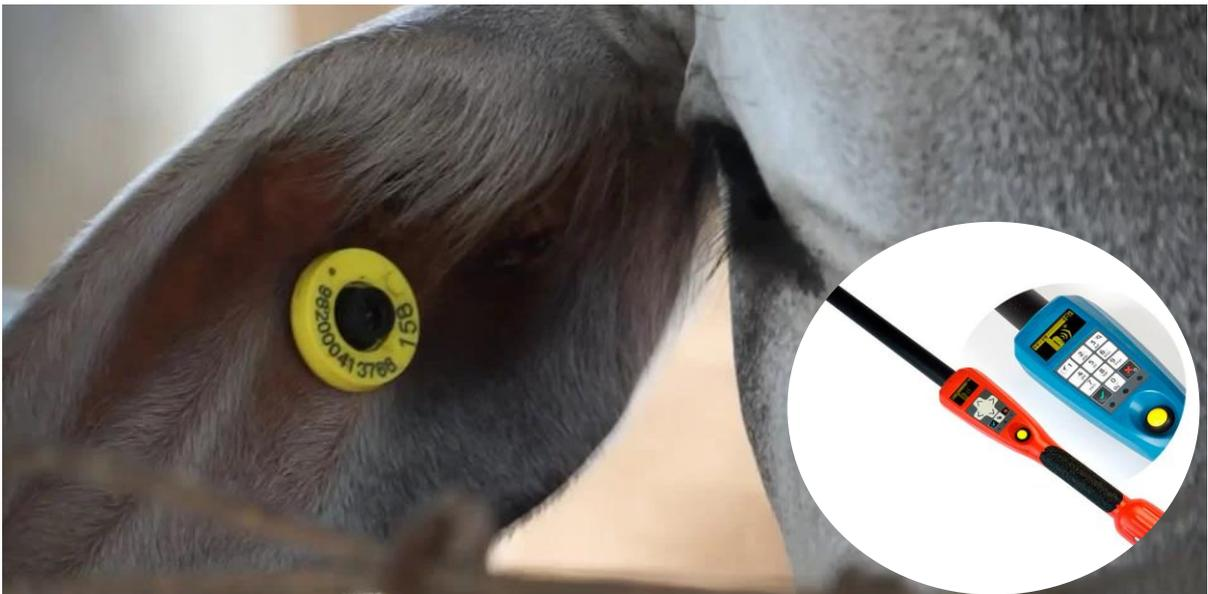
Figura 3 – Brinco com chip eletrônico utilizado no manejo de leitura de dados através do bastão eletrônico.
