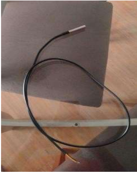
Figura 05. Sensor de Temperatura DS18B20. Fonte: "autores"
