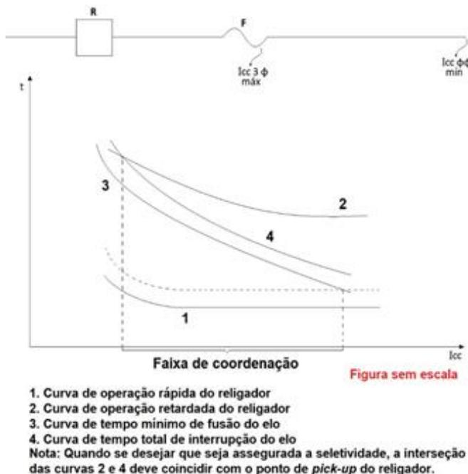
Figura 5 - Curvas para religamento coordenado com elo fusível do lado da carga.
