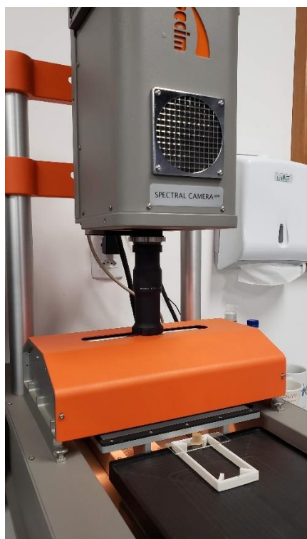
Figura 11: Câmera hiperespectral SisuCHEMA com o batoque contendo uma amostra para aquisição das imagens.
