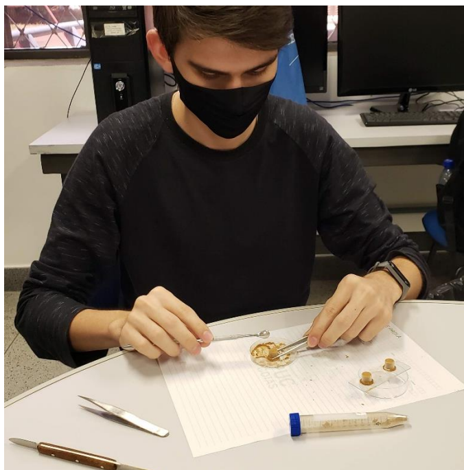
Figura 8: Processo de transferência de uma amostra para os batoques.
