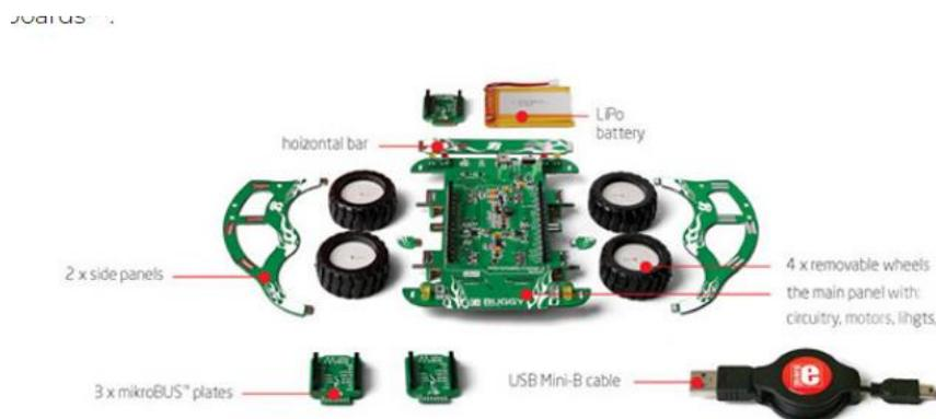
**Figura 10: Componentes do projeto Buggy (<https://www.mikroe.com/buggy>)**
