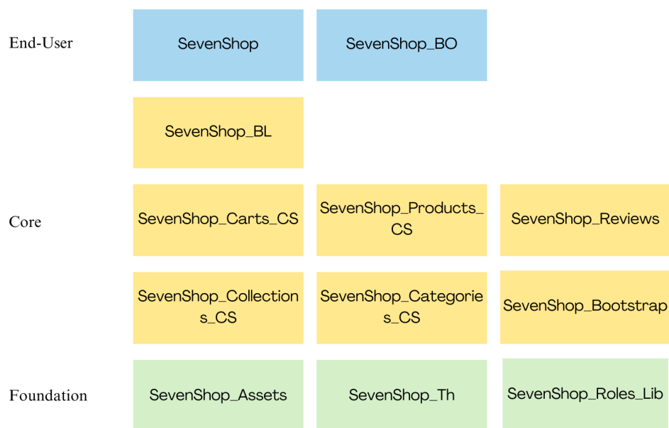
Figura 23 - Arquitetura em camadas dos módulos da aplicação.
