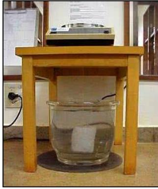
**Figura 5:** Balança Hidrostática. Fonte: Imagem da Internet, <https://www.todamatéria.com.br/hidrostatica>
