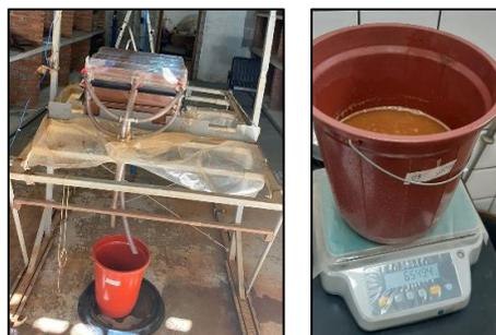
**Figura 4:** Balde localizado abaixo do SC para captação do material e depois pesado.
