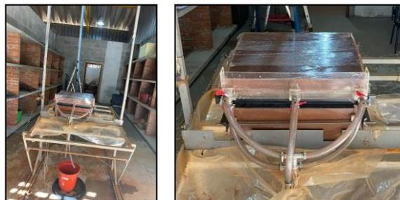
**Figura 2:** Solo moldado na caixa acrílica colocado no SC.
