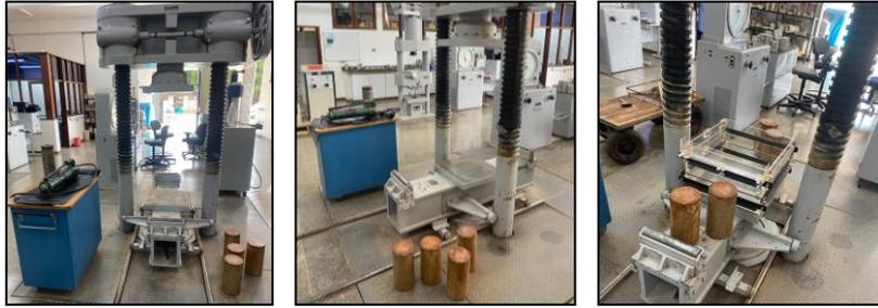
**Figura 1:** Prensa hidráulica (Máquina de ensaios em compressão/tração, prensa fabricante Maruto, capacidade de carga: 500 tf)
