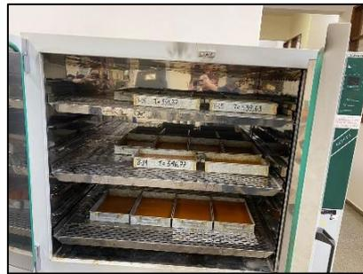
**Figura 6:** Foto das bandejas com solo na estufa.
