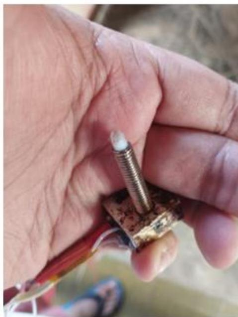
Tubo de filamento completamente destruído
