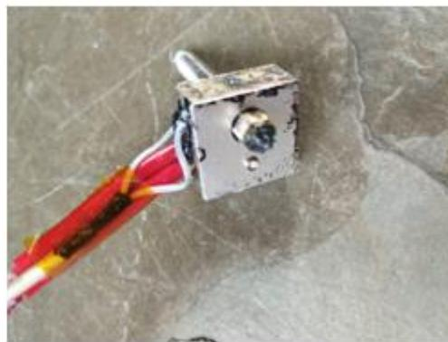
Bico de filamento completamente entupido
