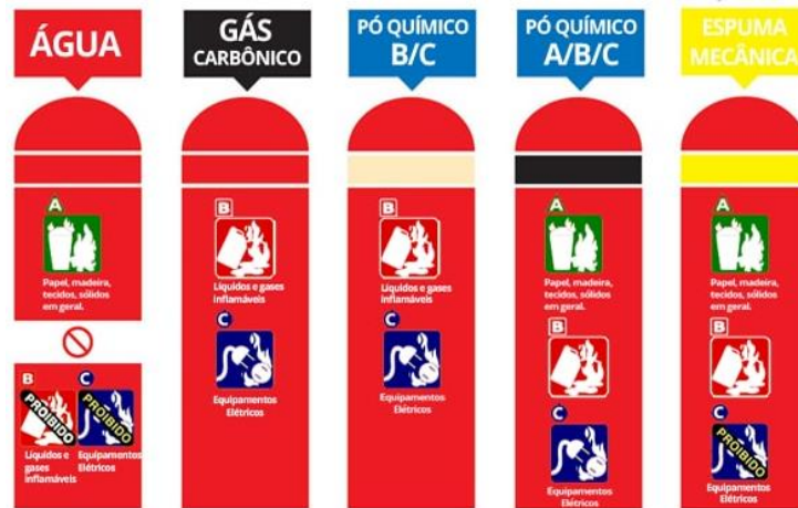
Figura 2. Tipos de extintores. Fonte: PEREIRA (2018)
