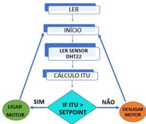
Fig. 9. Fluxograma ON/OFF Fonte: O Autor.
