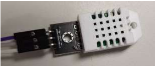
Fig. 5 Sensor de Temperatura e Umidade DHT 22. Fonte: O autor.
