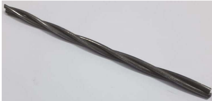
Figura 2.10 – Cordoalha de 7 fios engraxada.
