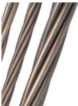
Figura 2.8 – Cordoalha de 7 fios não engraxada.
