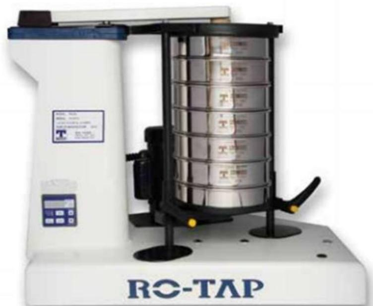
Figura 1: Agitador de peneira com braço mecânico.
