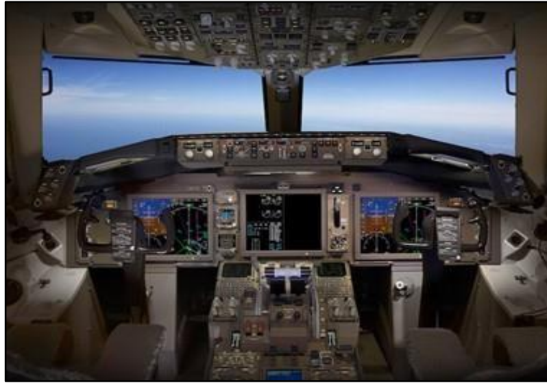
Figura 1: Cabine de um B767, conceito glass cockpit
