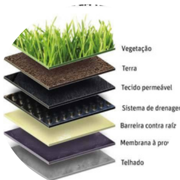
Figura 5: Telhado verde Fonte: https://celere-ce.com.br/
