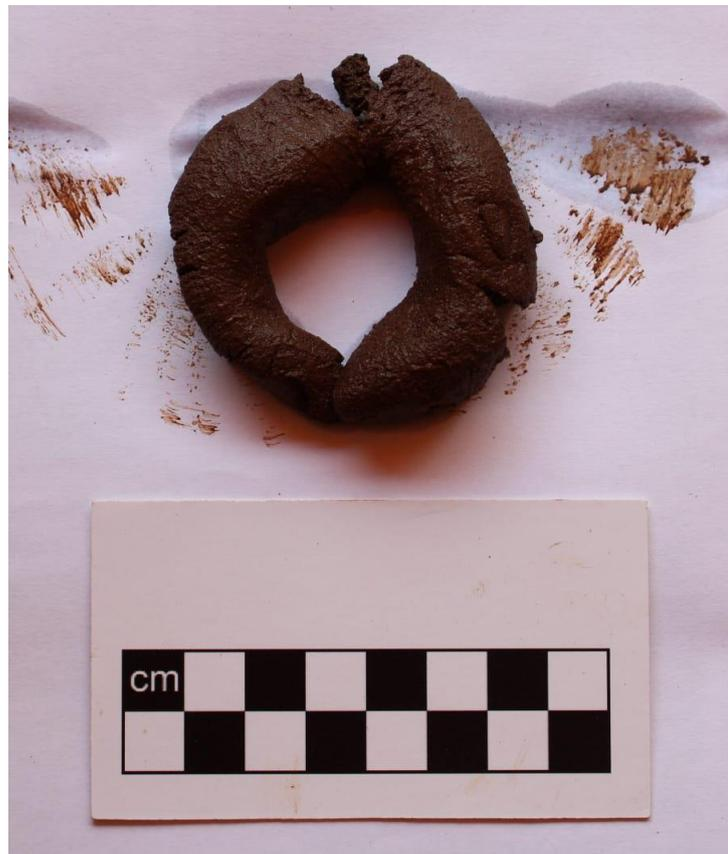
**Figura 26.** Teste de plasticidade do solo da amostra 2 do perfil 1.
