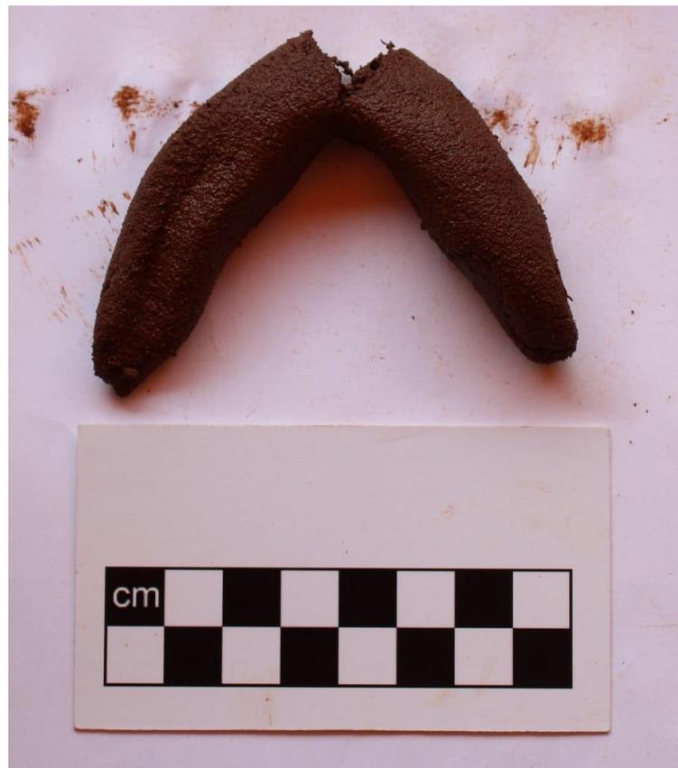
**Figura 30.** Teste de plasticidade do solo da amostra 3 do perfil 1.
