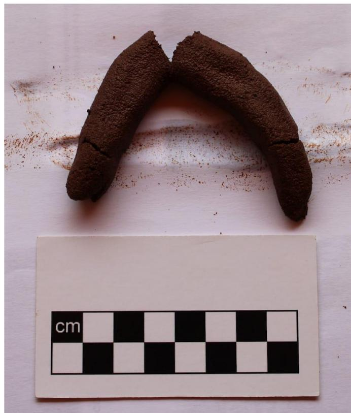
**Figura 38.** Teste de plasticidade do solo da amostra 1 do perfil 2.
