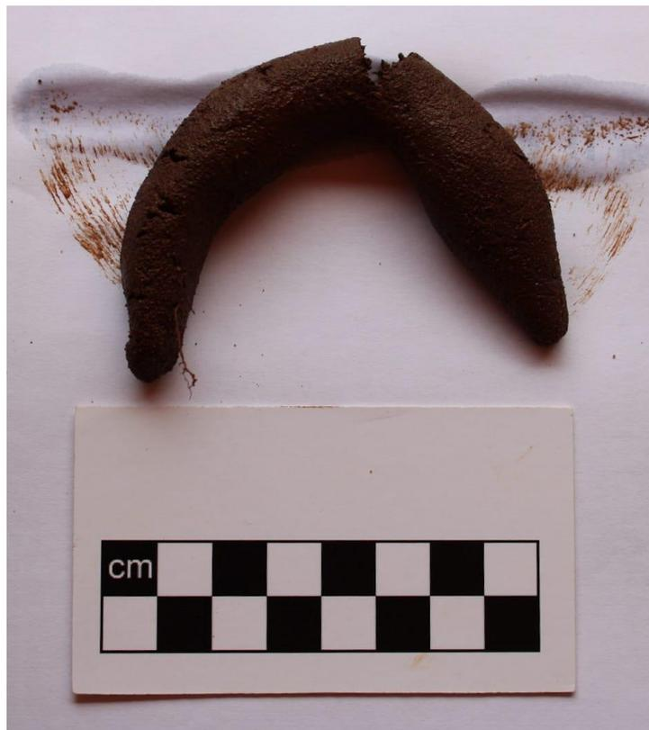
**Figura 50.** Teste de plasticidade do solo da amostra 4 do perfil 2.
