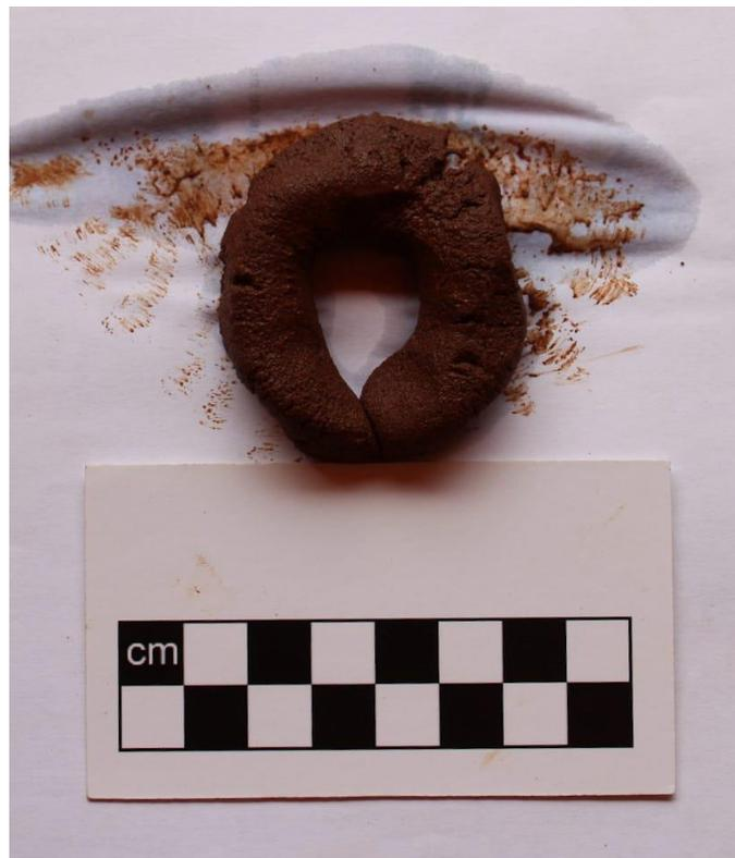
**Figura 42.** Teste de plasticidade do solo da amostra 2 do perfil 2.
