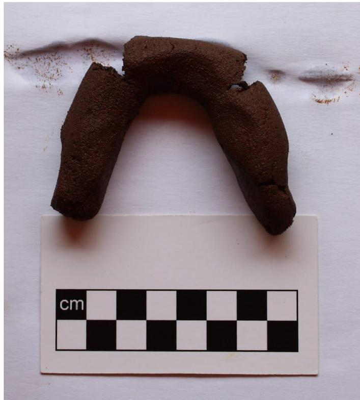
**Figura 22.** Teste de plasticidade do solo da amostra 1 do perfil 1.
