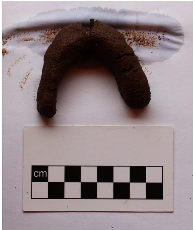
**Figura 46.** Teste de plasticidade do solo da amostra 3 do perfil 2.
