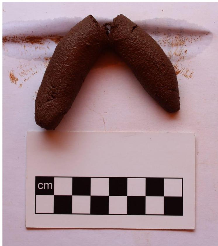
**Figura 34.** Teste de plasticidade do solo da amostra 4 do perfil 1.
